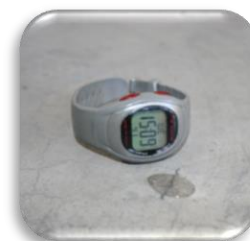
Absorption du support : essai à la goutte d'eau. La durée d'absorption du support doit être entre 60 et 240 s.
